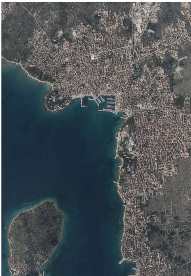
Ovisno o namjeni, aerofotogrametrijski snimci se prikupljaju s raznih visina leta iznad terena, tj. u raznim rezolucijama, tzv. Ground Sampling Distance (GSD) – veličina pixela na zemlji. Istovremeno se bilježi vidljivi (pankromatski) dio spektra te RGB boje (crvena-zelena-plava) i blisko infracrveni spektar (Near InfraRed - NIR).
