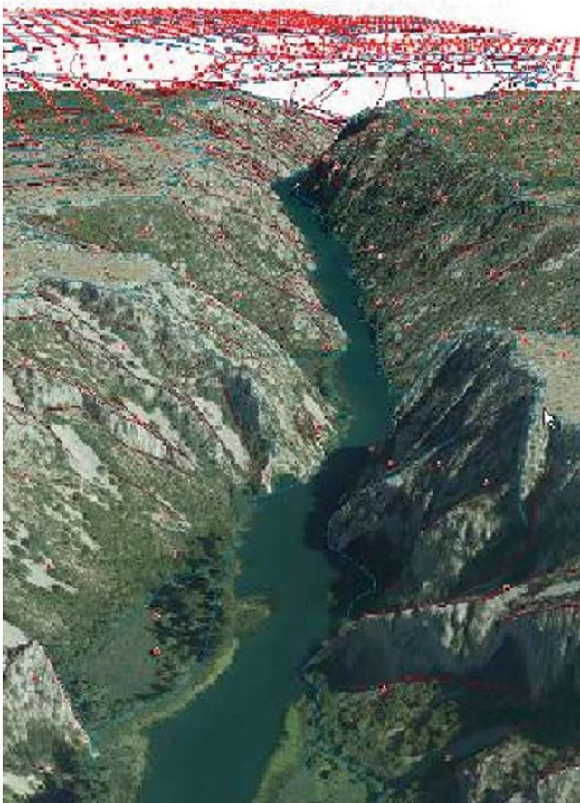
DMR treba biti korišten s posebnom pažnjom kod projekata s iznimno visokim zahtjevima u pogledu točnosti, vodeći računa o mjerilu snimanja iz zraka.
