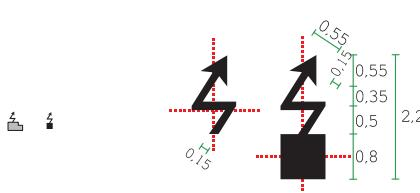
Za mjerila od 1:500 do 1:10 000, prikaz energetskih objekata (hidroelektrana, termoelektrana, plinska elektrana, nuklearna elektrana, plinara, toplana, transformatorska stanica) isti je kao i za „2.3.1. Gospodarske i industrijske zgrade (radionica, hala)“. Uz prikaz energetskog objekta ili u njemu prikazuju se kratice (npr. „HE“, vidi „11. POPIS KRATICA“), osim na katastarskim planovima.
