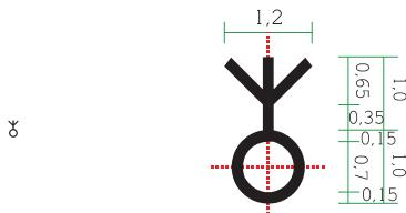
Za mjerila od 1:500 do 1:10 000, odašiljač, prijamnik ili antena prikazuje se istim prikazom kao i „2.3.1. Gospodarske i industrijske zgrade (radionica, hala)“, ako su tlocrte površine veće od  $10 \text{ m}^2$ , s time da se, za potrebe katastra vodova, na prikaz stavљa i znak. Manji objekti se prikazuju znakom. Odašiljači, prijamnici i antene prikazuju se na topografskim kartama.
