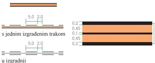
Za mjerila od 1:20 000 do 1:25 000, autocesta u izgradnji prikazuje se isprekidanom linijom.
