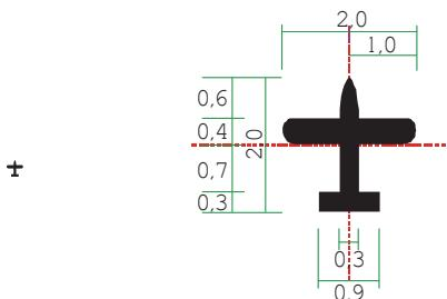
Za mjerila od 1:500 do 1:10 000, zgrada zračne luke prikazuje se kao javna zgrada, a rubovi zrakoplovnih pisti linijama kojima se prikazuju granice vrste uporabe zemljišta. Znak (avion) postavlja se na prikaz piste u smjeru njezina pružanja.
