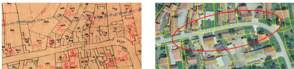
Slika 1. Deformacije nastale nepravilnim spajanjem skeniranih analognih planova.
