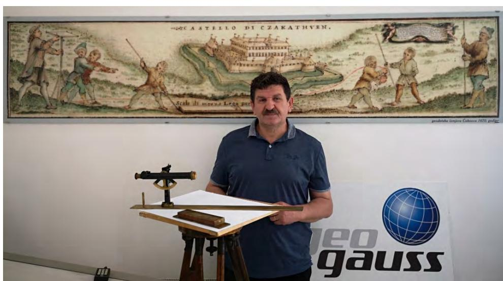
Katastarski planovi grafičke izmjere nastali su većinom u 19. stoljeću grafičkom metodom izmjere - geodetskim stolom (potrebno je razumjeti vremenski kontekst nastanka, koja oprema je korištena, kakvom metodom je mjereno, u koju svrhu je mjereno, kakva se točnost mogla postići i dr.).
